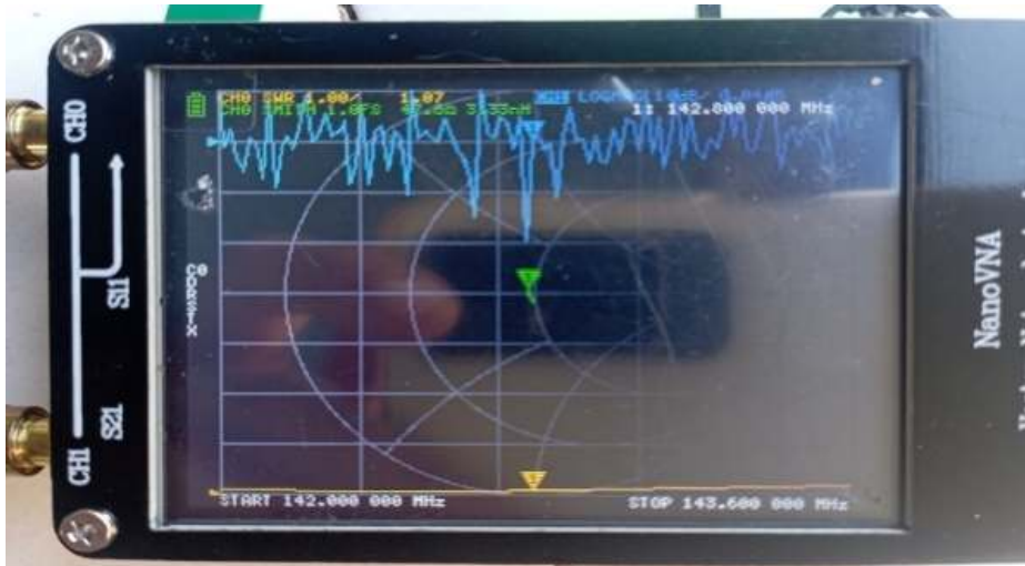
Gambar 2. Pengukuran dan kalibrasi kabel coaxial RG-58
