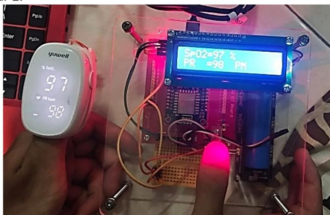
Gambar 2. Pengujian alat dengan YX102 Oximeter
