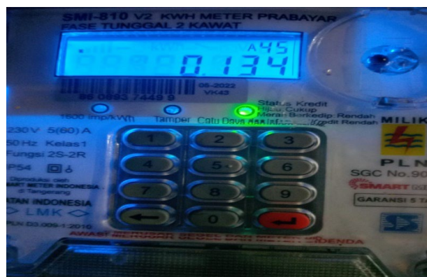
Gambar 9. Tampilan Parameter Arus Hasil Pembacaan kWh meter Prabayar
