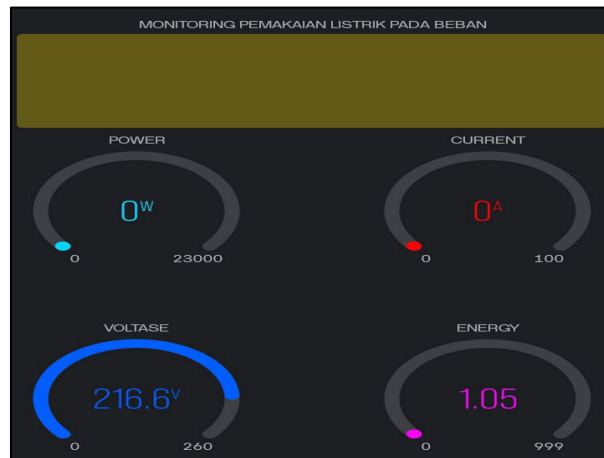
Gambar 13. Gauge Monitoring Pemakaian Listrik Pada Aplikasi Blynk
