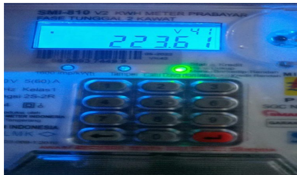
Gambar 8. Tampilan Parameter Tegangan Hasil Pembacaan kWh meter Prabayar
