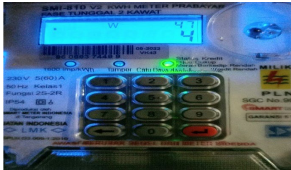
Gambar 7. Tampilan Parameter Daya Hasil pembacaan kWh meter Prabayar
