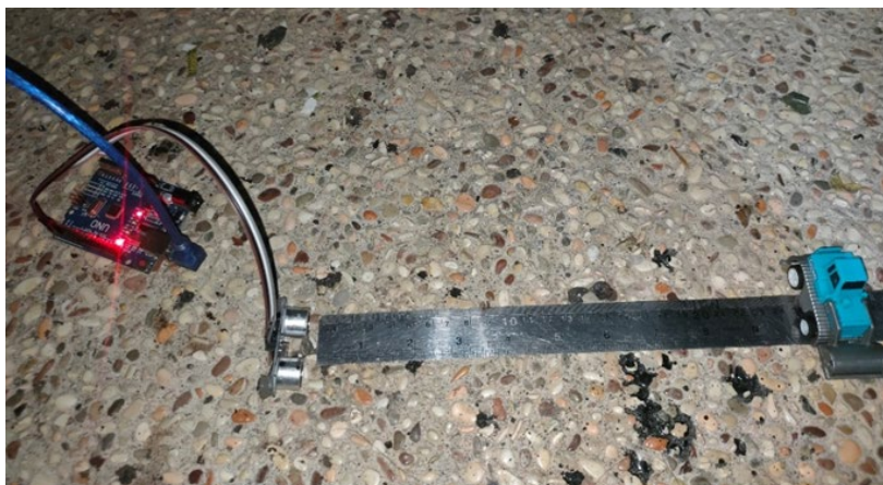
Gambar 5. Pengujian Sensor Ultrasonik Terhadap Objek
