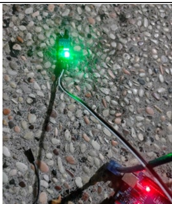
Gambar 11. Pengujian Sensor Infrared Tidak Terhalang Objek
