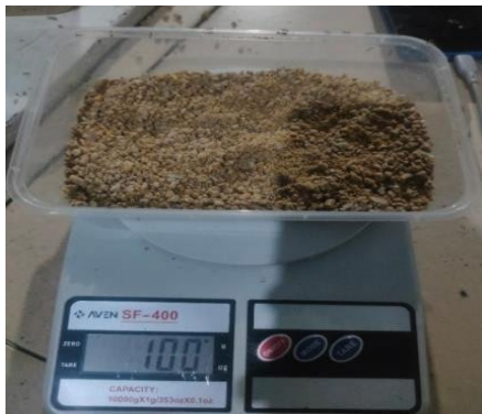
Gambar 2. Pengujian Kondisi Berat Beban Gambar 3. Tampilan Hasil Kalibrasi Pada LCD
