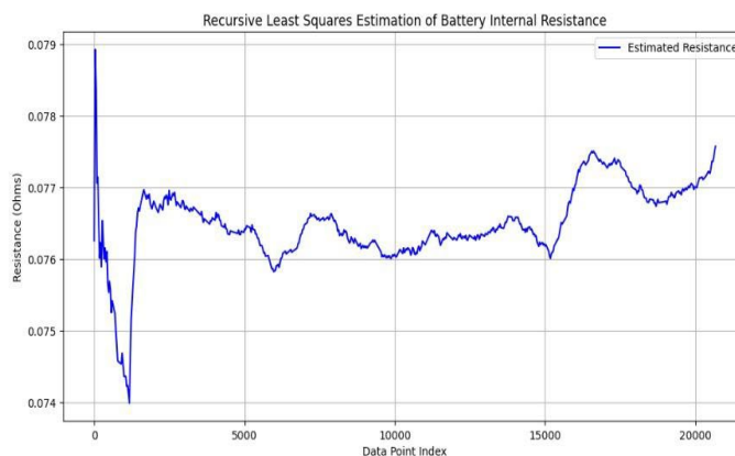
Gambar 3. Resistansi Internal Baterai Menggunakan Algoritma Recursive Least Squares (RLS)
